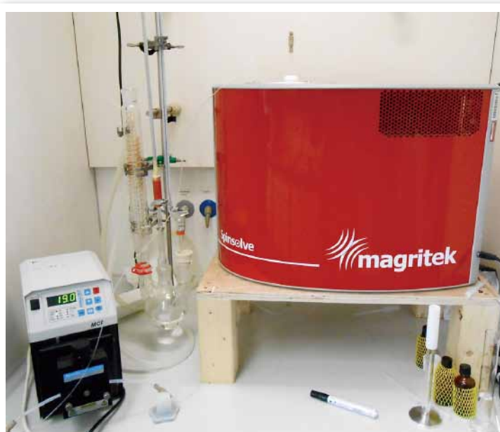
Spinsolve NMRスペクトロメータをヒュームフードに設置し バッチ反応をリアルタイムモニタリングできる
